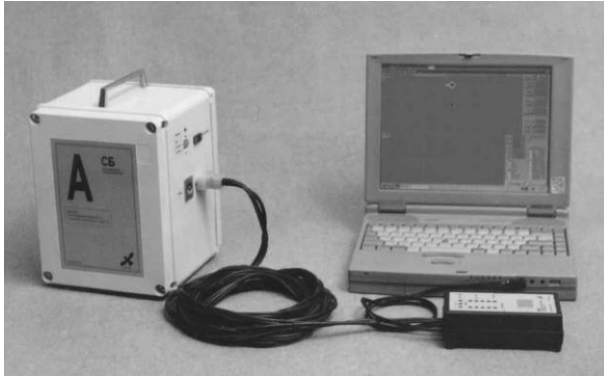
Рис.3.3. СБ, КП и МСБ течеискателя К-10.2 в рабочем режиме.
