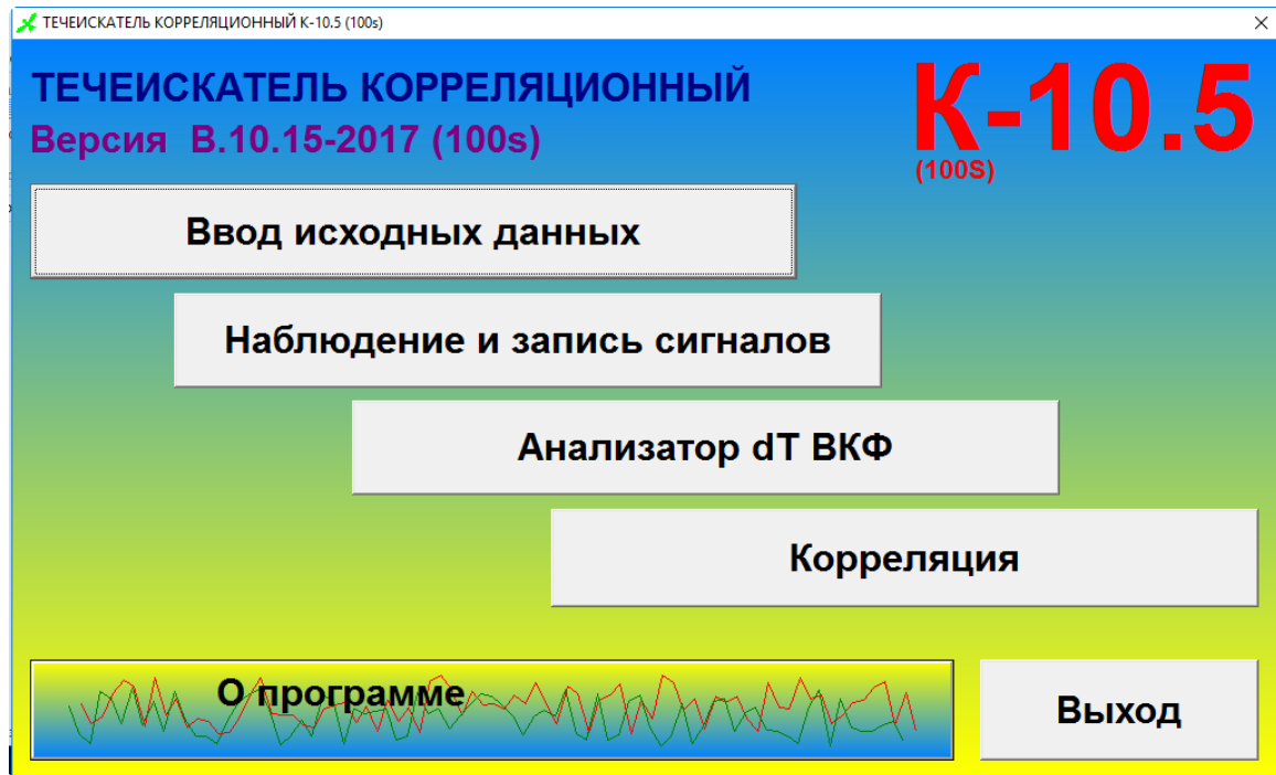
Рис.4. Головное меню течеискателя К-10.5м2
