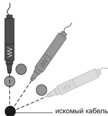
Рисунок 5.4.2 – Поиск кабеля (жилы) по минимуму сигнала
